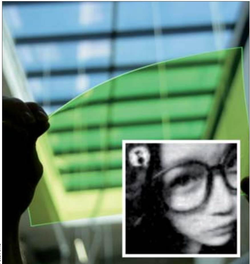
Transparenter und biegbare Bildsensor und Rekonstruktionsergebnis eines Bildes
