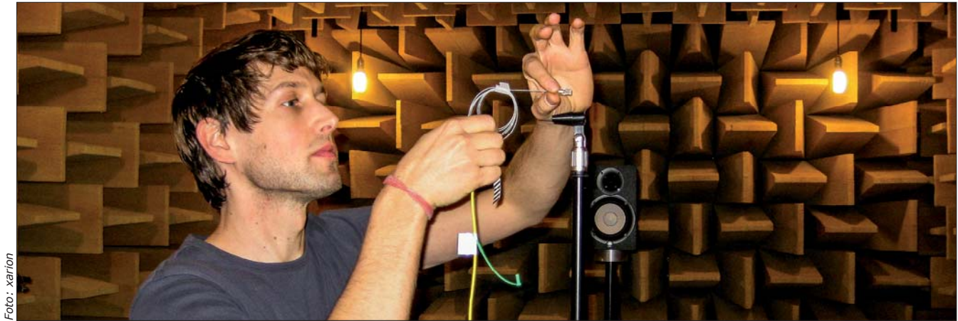
Balthasar Fischer mit seinem optischen Mikrofon bei Tests im schalltoten Raum
