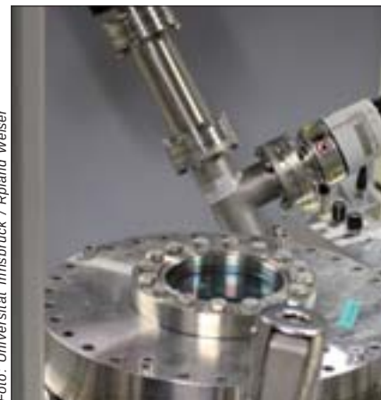
Das Herzstück der Ionenfallen-Apparatur, in der Vakuumkammer befindet sich die eigentliche Ionenfalle.
