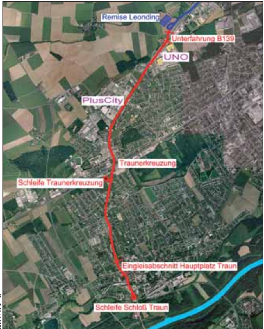
Die Verlängerung der bestehenden Straßenbahnlinie 3 beginnt im Bereich der im August 2011 von der LINZ AG eröffneten Remise Leonding. Die Gesamtlänge der Verlängerung der bestehenden Straßenbahnlinie 3 beträgt rund 4,5 km und endet in der Schleife Schloß Traun.
