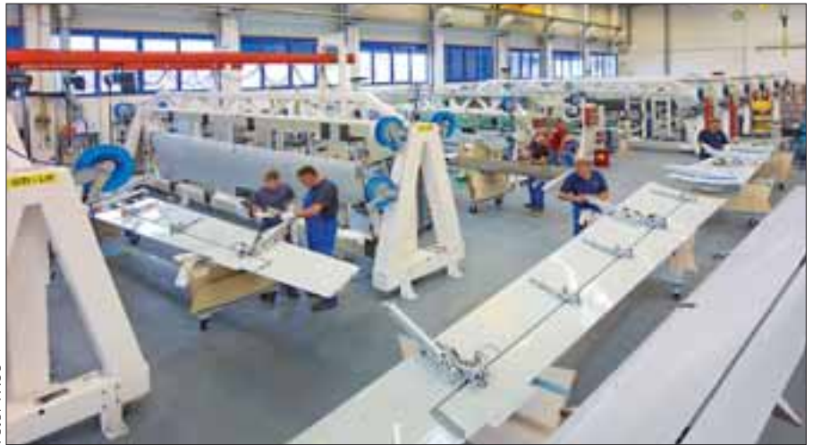
FACC Fertigungsstraße für Landeklappen der A321neo
