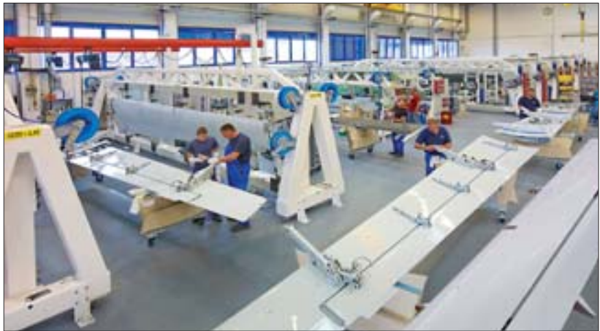
FACC Fertigungsstraße für Landeklappen der A321neo
