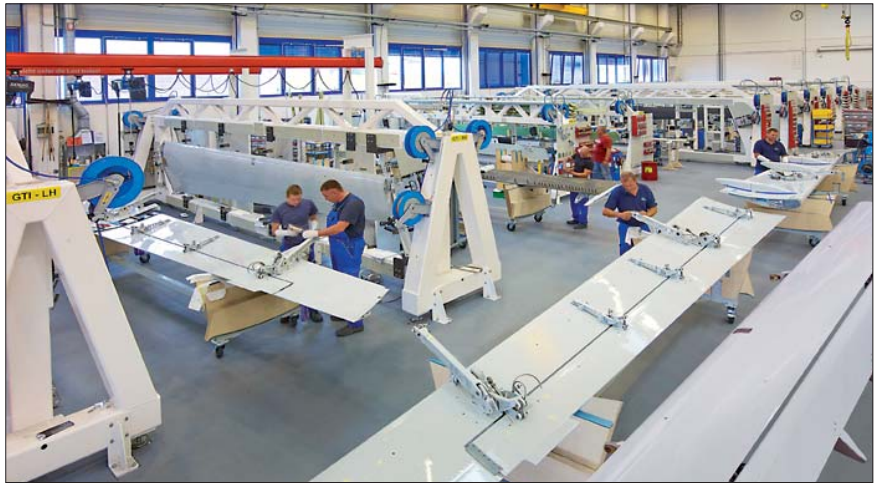
FACC Fertigungsstraße für Landeklappen der A321neo
