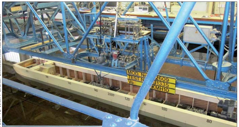
oben: Entwurf für einen neuen Schiffstyp, unten: im Schleppversuch
