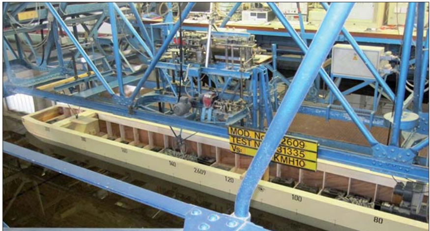
oben: Entwurf für einen neuen Schiffstyp, unten: im Schleppversuch
