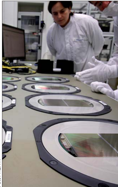
Mehrere Siliziumdetektoren von Infineon im HEPHY Reinraum
