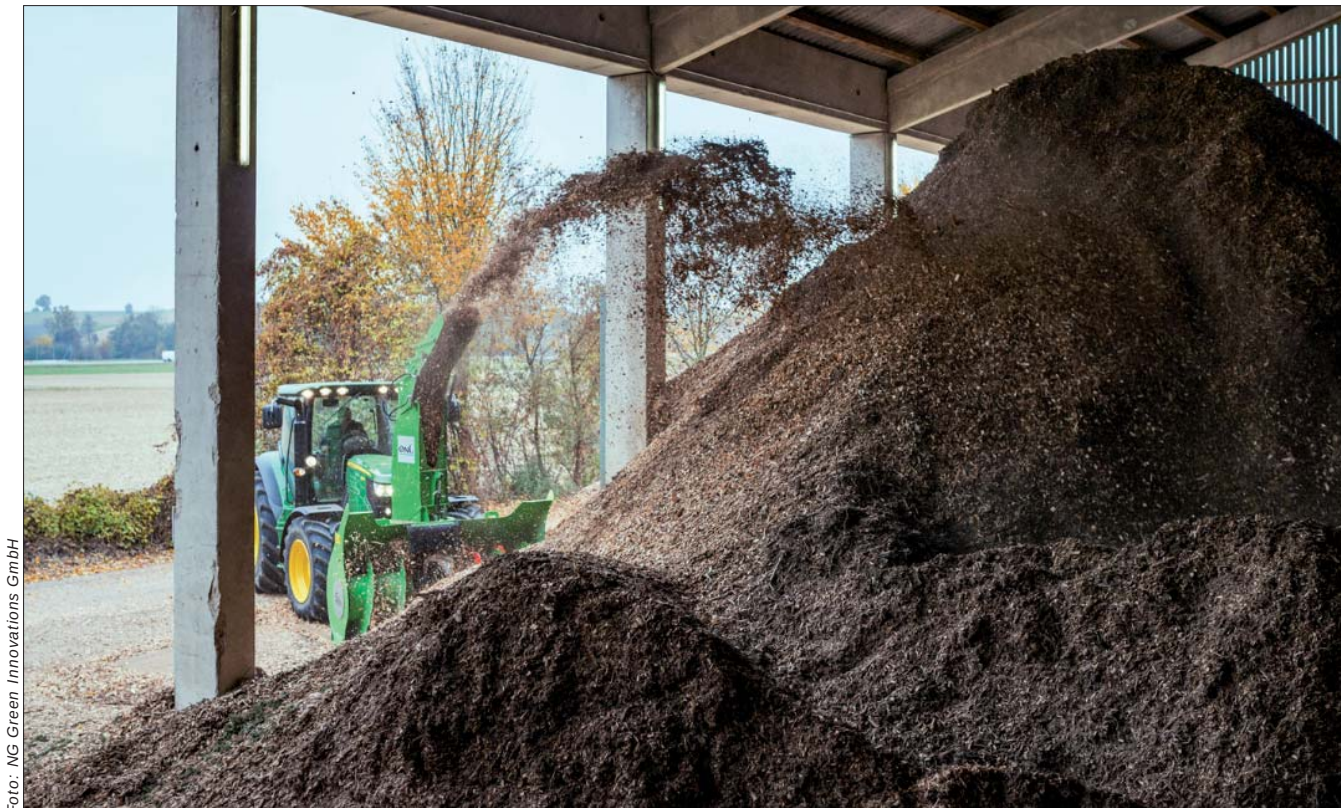
Der Fräsinator eco 3.0 schafft Raum in Lagerhallen: durch den Auswurf von Schüttgut auf eine Höhe von bis neun Meter
