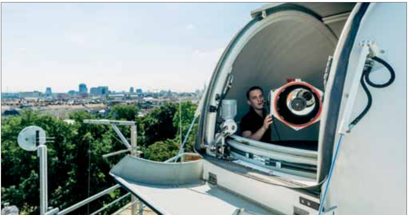
Das »Hedy Lamarr Quantum Communication Telescope« der Österreichischen Akademie der Wissenschaften (ÖAW) und der Universität Wien am Dach des ÖAW-Instituts für Quantenoptik und Quanteninformation ist eine der Bodenstationen des QUESS-Projekts und wird verschränkte Photonen des Satelliten empfangen.
