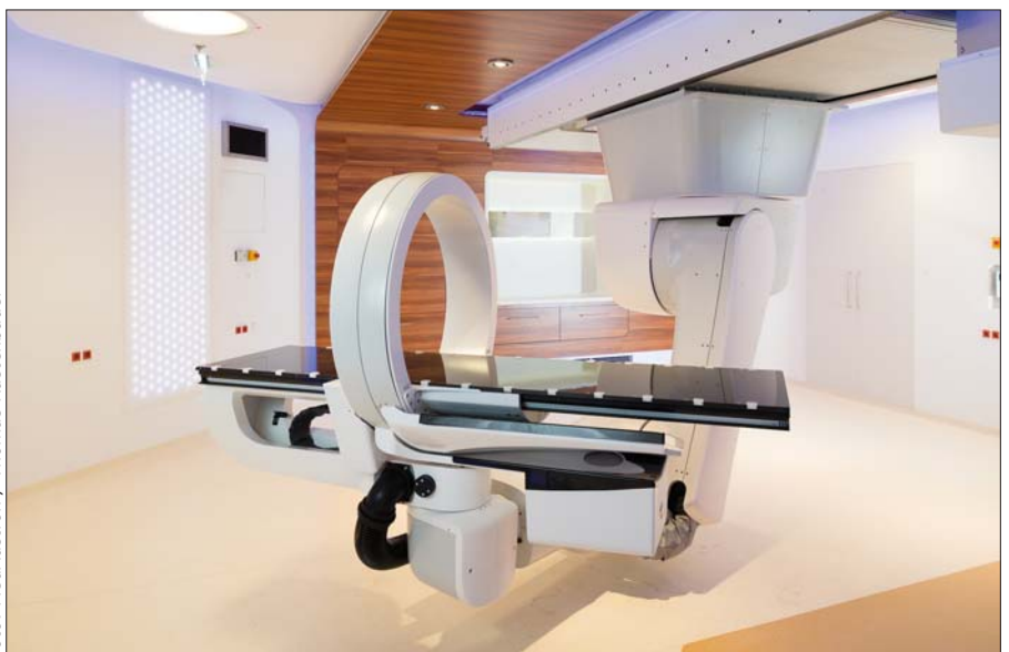
Innovatives Rotobersystem mit Imaging Ring zur Positionierung und Positionsüberwachung der PatientInnen
