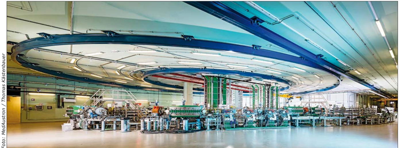
Der kreisförmiger Teilchenbeschleuniger »Synchrotron« ist das Herzstück der hochkomplizierten Anlage in Wr. Neustadt
