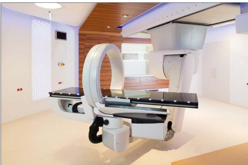
Innovatives Rotobersystem mit Imaging Ring zur Positionierung und Positionsüberwachung der PatientInnen
