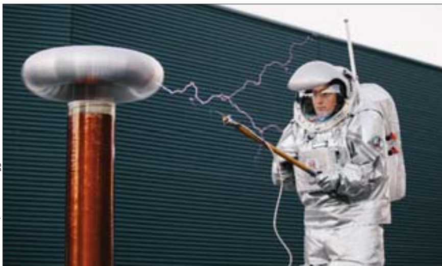
Mit 6 Millionen Volt wurde ca. 200 mal pro Sekunde auf eine Metallspitze entladen, die der Anzugträger hielt.
