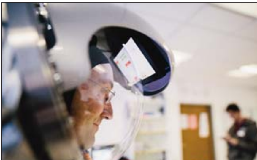
Die Sensoren des Lebenserhaltungssystems des Raumanzuges werden im Labortest vermessen, hier die Temperaturfühler im Anzug.
