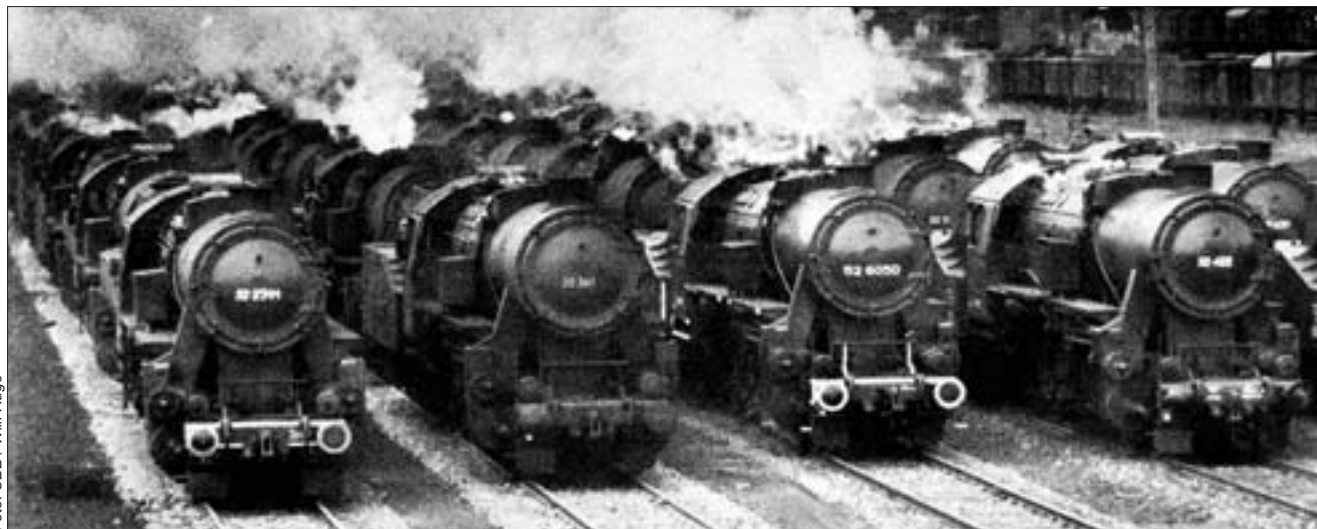
Von der Kriegslokomotive Baureihe 52 wurden an 1942 rund 7000 Exemplare gebaut.
