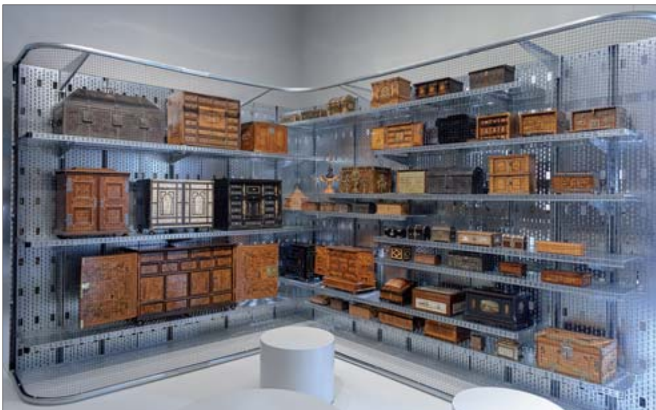
Das Konzept der Innenraumgestaltung der historischen Räumlichkeiten im Palais Herberstein basiert auf einer fließenden Wandverkleidung aus Metallkabeltassen, die gleichzeitig als Träger der Exponate dienen.
