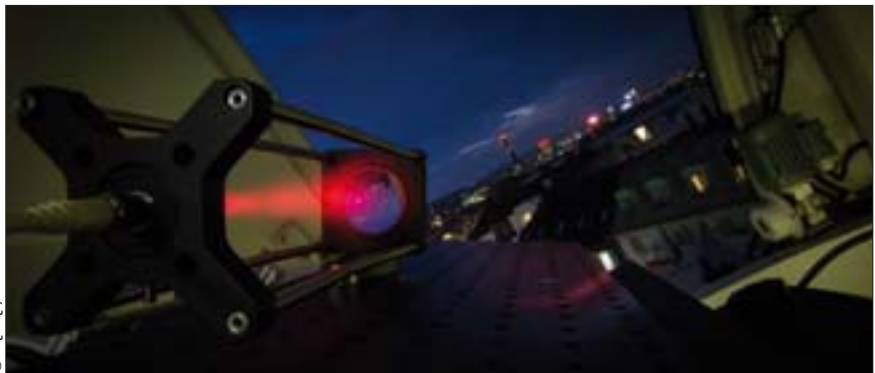
Bei Nacht. Der augensichere rote Justagelaser wurde mittels Langzeitbelichtung und einem Blatt Papier, das durch den Strahlengang gezogen wurde, sichtbar gemacht.
