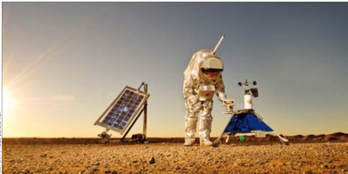
Der Hunveyor ist ein weiteres ungarisches Experiment. Der Lander dient u.a. auch als Wetterstation und sammelt damit auch wichtige Winddaten für das MEDIAN Experiment.
