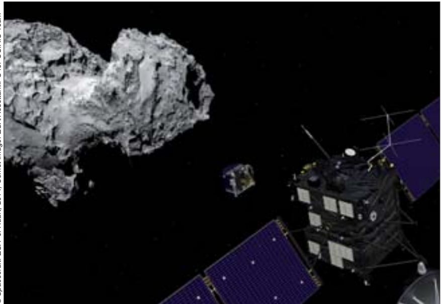
Visualisierung vom Rosetta-Orbiter, der den Philae-Lander zum Kometen 67P / Churyumov-Gerasimenko einsetzt. Das Bild ist nicht maßstabsgetreu; die Rosetta-Sonde mißt 32 m einschließlich der Sonnensegel, während der Kometenkern etwa 4 km breit sein soll.
