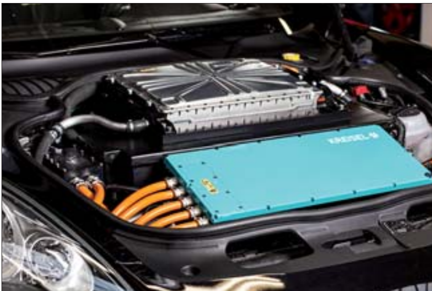
Zum Beispiel Porsche Panamera 4S: Die große Herausforderung bestand darin, dessen Allradtechnik ohne Leistungsverlust beizubehalten. Dafür wurde das sportliche 7-Gang-Automatik-Getriebe mit einem leistungsstarken Elektroantrieb von Kreisel Electric kombiniert. Das Ergebnis: Full electric 4WD mit 360 kW Leistung.
