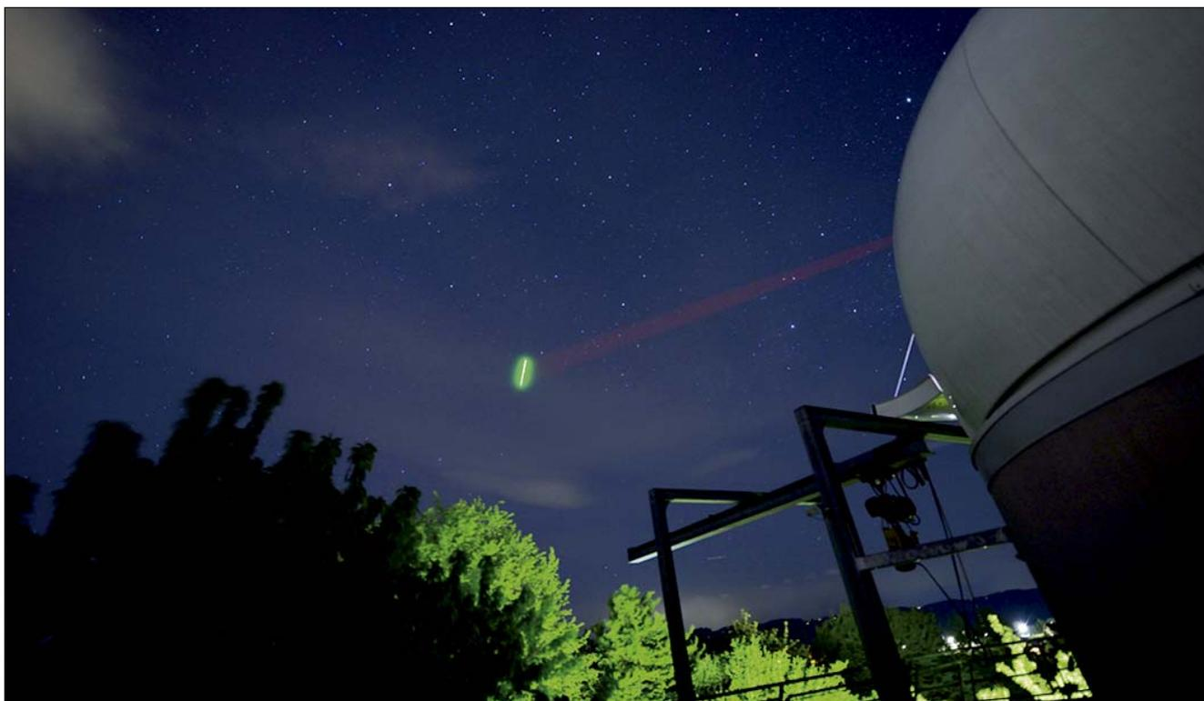
*Zwischen der Bodenstation am Observatorium Lustbühel in Graz und dem Satelliten »Micius« wurden mithilfe ausgetauschter Lichtteilchen Quantenschlüssel zur Chiffrierung und Dechiffrierung von Information erzeugt.*
