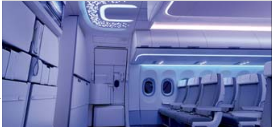
Neben den XL Bins und Deckenpaneelen entwickelt und fertigt FACC auch die Entrance Area der neuen Airspace Kabine für die A320 Familie.
