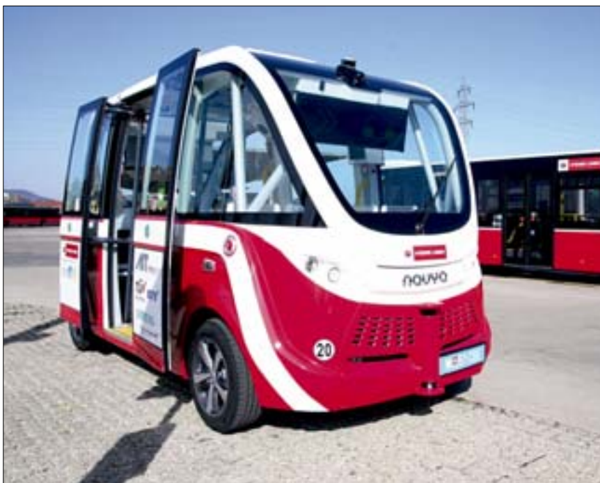
Der NAVYA-Bus verfügt über zwei lenkbare Achsen, wovon eine von einem Elektromotor angetrieben wird. Die Spannung der Batterie soll Hersteller bis zu neun Stunden halten.
