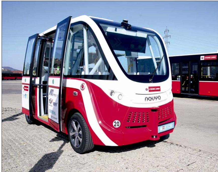
Der NAVYA-Bus verfügt über zwei lenkbare Achsen, wovon eine von einem Elektromotor angetrieben wird. Die Spannung der Batterie soll Hersteller bis zu neun Stunden halten.
