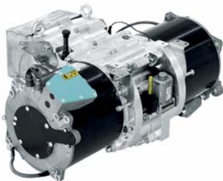
Die Kreisel Sala 2-speed transmission (oben) und deren Einzelteile (unten)
