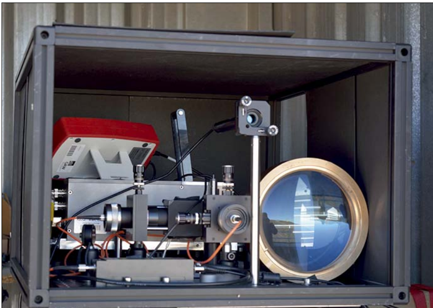
Eine der zwei mobilen Empfangsstationen für verschränkte Photonen, die von den Quantenphysikern der Österreichischen Akademie der Wissenschaften (ÖAW) auf La Palma für die Messung der Verschränkung eingesetzt wurde.
