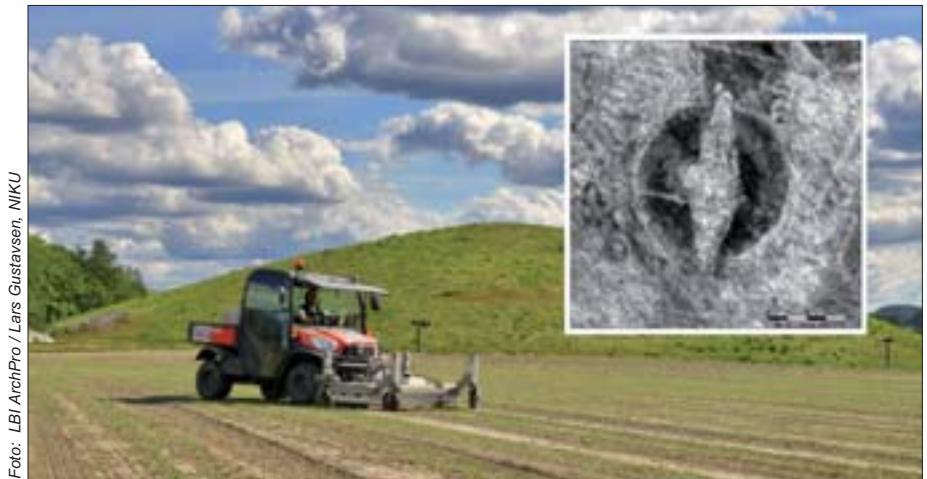
Das mit dem Bodenradar ausgestattete Fahrzeug »tastet« jeden Quadratzentimeter ab.
