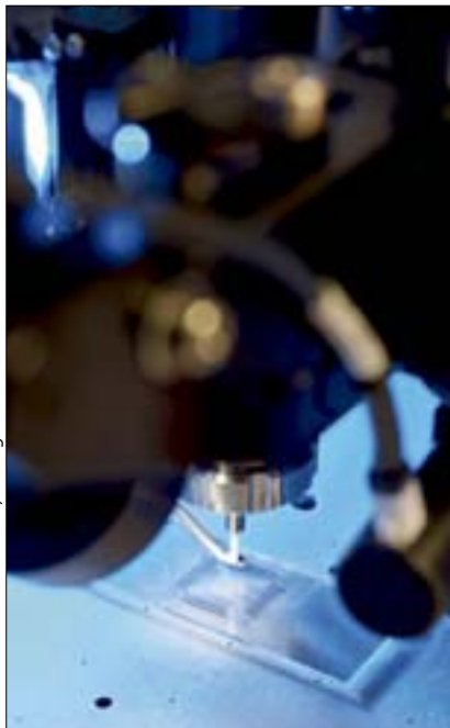
Mit einem Aerosol-Jet-Drucker können elektronische Komponenten aufgedruckt werden.
