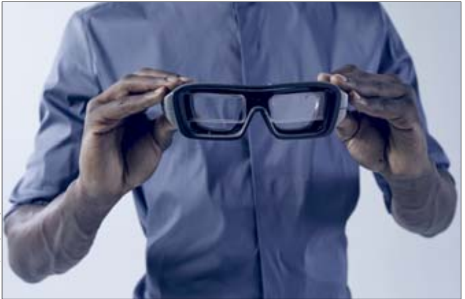
Die „VPS 19“-Datenbrille wird durch Augen-Gesten und Blicke gesteuert.
