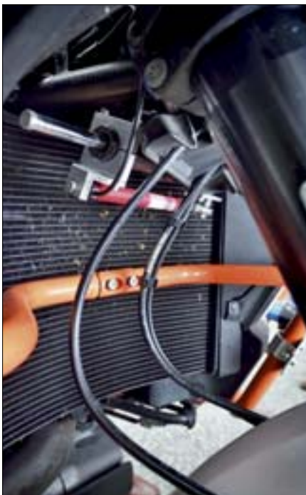
Mittels Lenkwinkelsensor und weiterer Sensorik werden Fahrdynamikdaten hochgenau erfaßt
