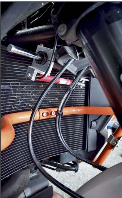
Mittels Lenkwinkelsensor und weiterer Sensoren werden Fahrdynamikdaten hochgenau erfaßt
