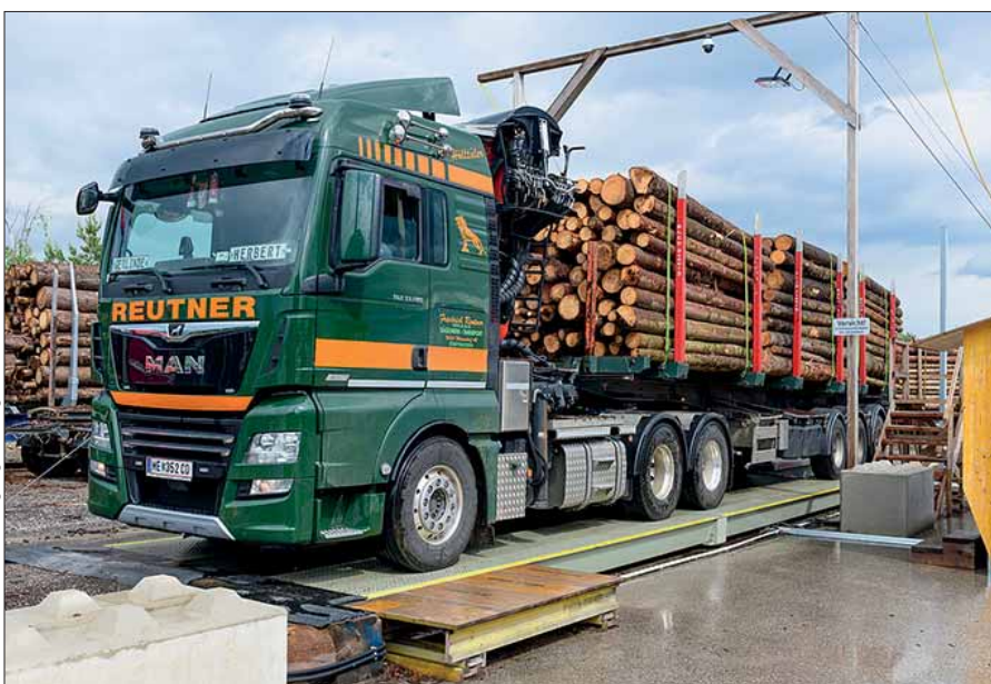
Mobile Brückenwaage - vollautomatische Verwiegung des Ladegutes
