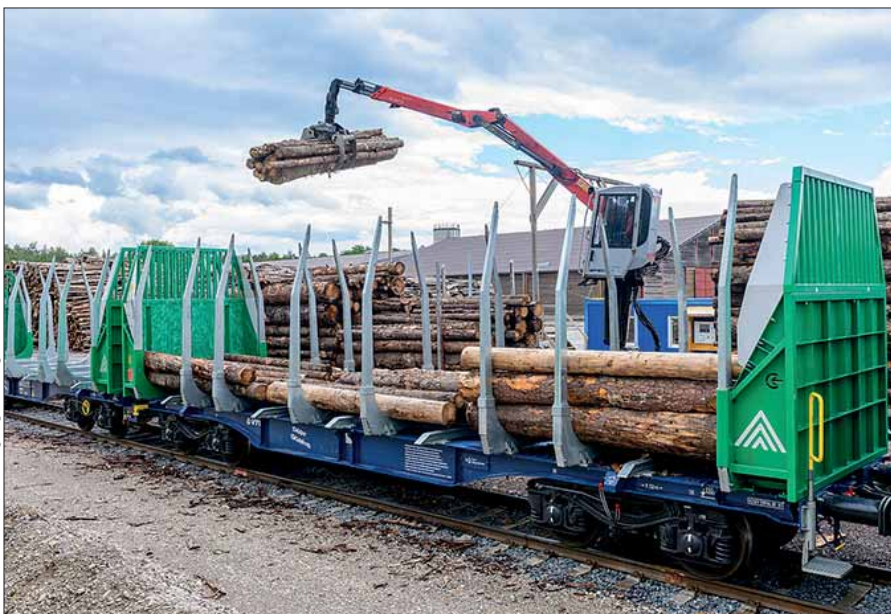
GigaWood-Waggons mit doppelter Ladekapazität
