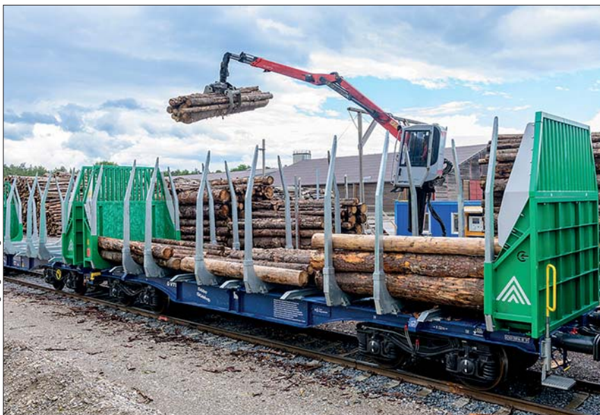
GigaWood-Waggons mit doppelter Ladekapazität
