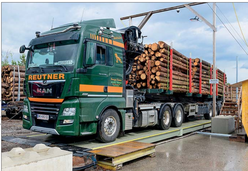
Mobile Brückenwaage - vollautomatische Verwiegung des Ladegutes
