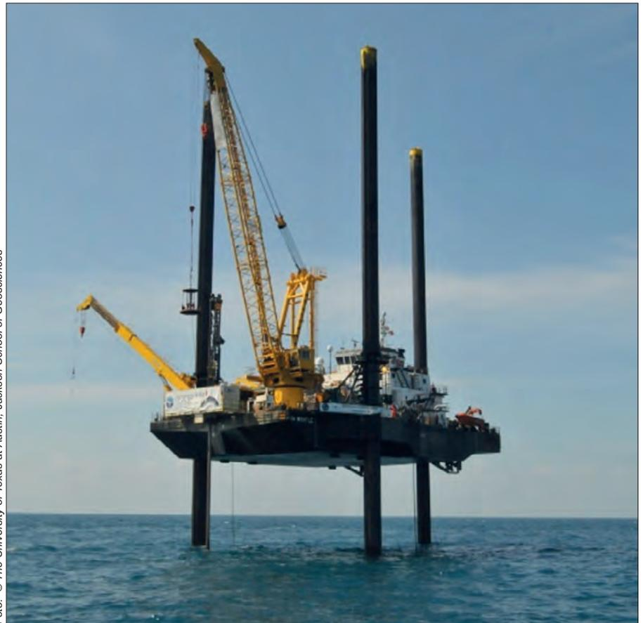
Hebeboot L/B Myrtle, das zum Bohren des Kerns verwendet wurde.
