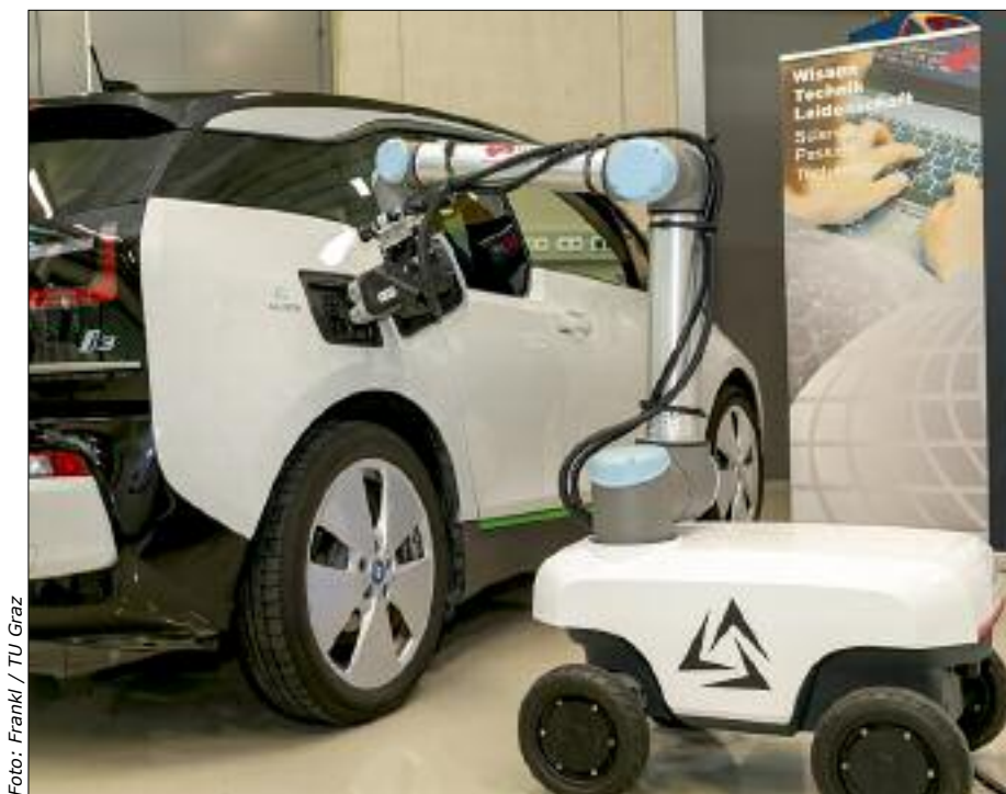
CHARBO, der in Zusammenarbeit mit der TU Graz und Arti Robots entwickelte, vollautonome Laderoboter
