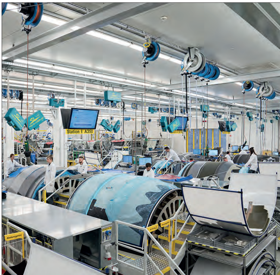
Fertigung von Schubumkehrgehäusen bei FACC im Cleanroom Werk 4: Eine getaktete Produktionslinie und schlanke Betriebsabläufe garantieren maximale Effizienz und Stabilität in der Produktion.
